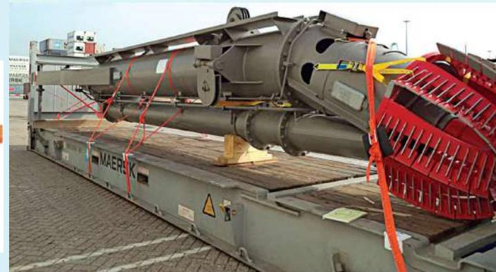
ターンバックルやシャックルは緩まないようにしっかりと固定する必要があります。ラッシングシステムの強度は、破断強度（BS）、ラッシング能力（LC）、最大固定重量（MSL）など、さまざまな名称で呼ばれています。MSL/LCはBSの50%とされています。
